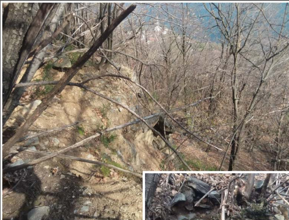
Foto 07 Pendio ripido in materiale sciolto nella parte centrale dell'area di studio, con possibile rimobilizzazione di sassi e blocchi.
